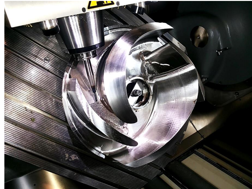
Sanacija rotora pumpe odsumporavanja – navarivanje, strojna obrada nakon navarivanja i dinamičko uravnoteženje
