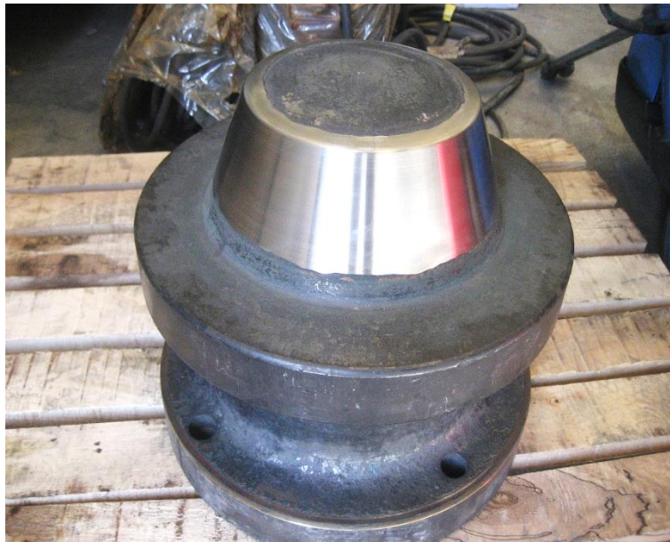
Navarivanje zapornog ventila – stelit
