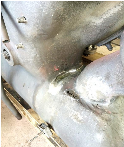
Sanacija pukotina na razdjelniku parne turbine – zavarivanje i toplinska obrada
