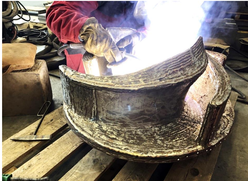
Sanacija rotora pumpe odsumporavanja – navarivanje, strojna obrada nakon navarivanja i dinamičko uravnoteženje
